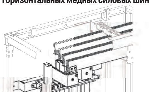
Комплект для подсоединения горизонтальных медных силовых шин,  $T = 5\text{ mm}$
